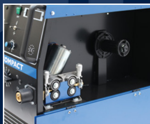
Amplio compartimento para bobinas de hasta 20kg ø 300mm
